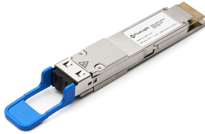
FIGURE 4. Exemple de QSFP (QDD-400G-LR8) commercialisé par FluxLight. Figure issue de [12].
