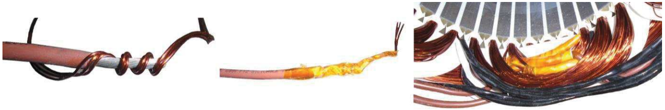
Figure 3. 8. Réalisation de piquages intermédiaires : insertion d'un câble au niveau du point de piquage des spires (gauche), soudure et isolation du point de piquage (centre) et insertion de la bobine et des piquages dans les encoches stator (droite).
