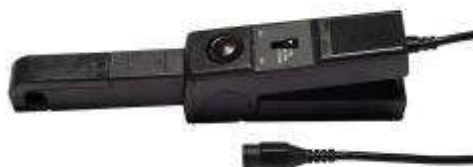
Figure B.2. 3. Sonde ampère-métrique Chauvin Arnoux série EN.
