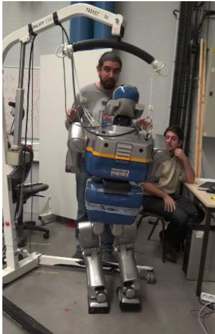
FIGURE 4.8 – Test du stabilisateur sur un pied.
