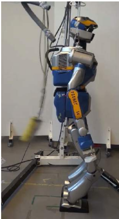
FIGURE 4.2 – Illustration des expériences de stabilisation : le robot subit plusieurs fois la même perturbation, de manière à comparer plusieurs versions du stabilisateur
