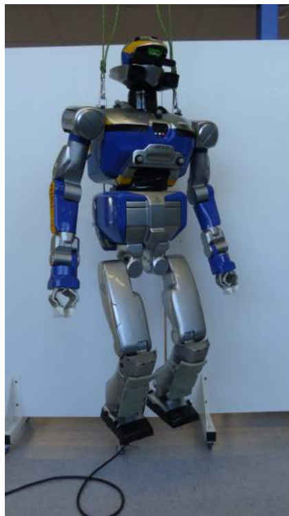
FIGURE 2.5 – Entre les différents tests, le robot HRP-2 peut être suspendu par des cordes au niveau des épaules.
