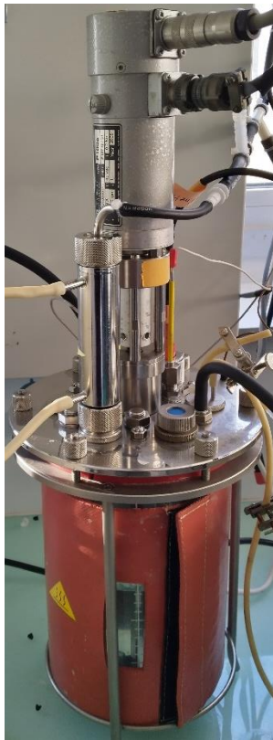
Figure 2-3 : Photo d'un réacteur instrumenté Applikon Bio 3L et schéma simplifié du dispositif expérimental lors des fermentations en mode batch.
