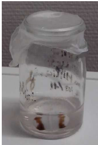
Figure 37 : Bactéries avec des magnétosomes collées à un aimant
