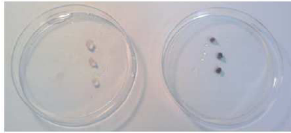
Figure 13 : Bactéries Burkholderia immobilisées dans des billes de silice avant (à gauche) et après (à droite) réduction du Cr (VI) (Alvarez et al. , 2011)
