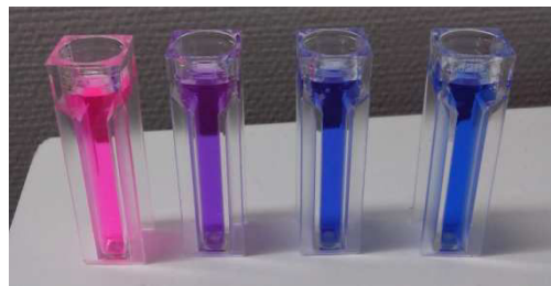
Figure 1 : Dosage de l'Alamar Blue réduit (la concentration en bactérie diminue de gauche à droite)
