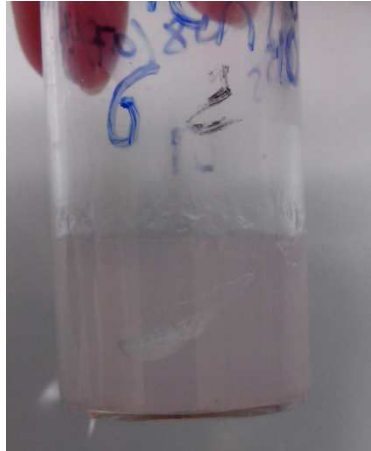
Figure 30 : Fracture d'un gel de silice après 7 jours d'encapsulation qui pourrait être due à un dégagement gazeux des bactéries encapsulées
