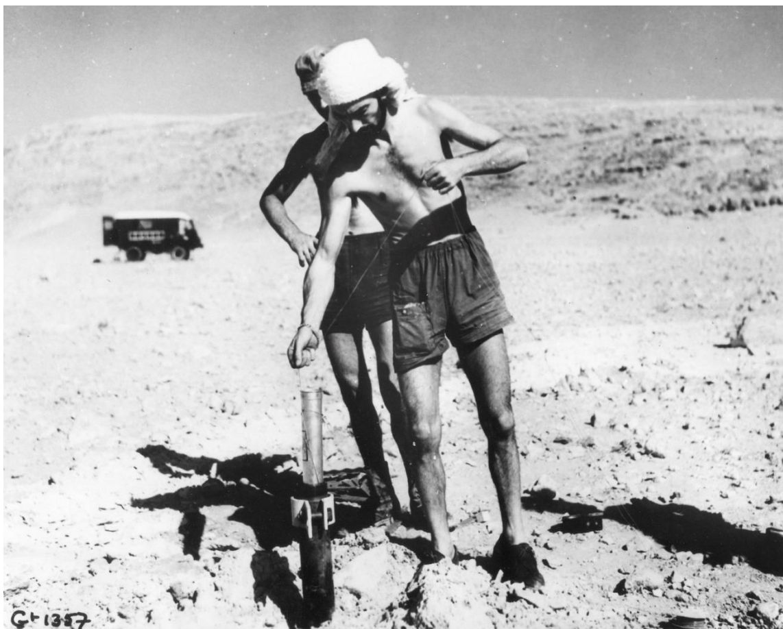
Photo 7 Préparation d'une explosion sismique : géophysiciens mettant une charge en place au Sahara, 1959 - Photothèque Historique Total, 101307, Guyot ©
