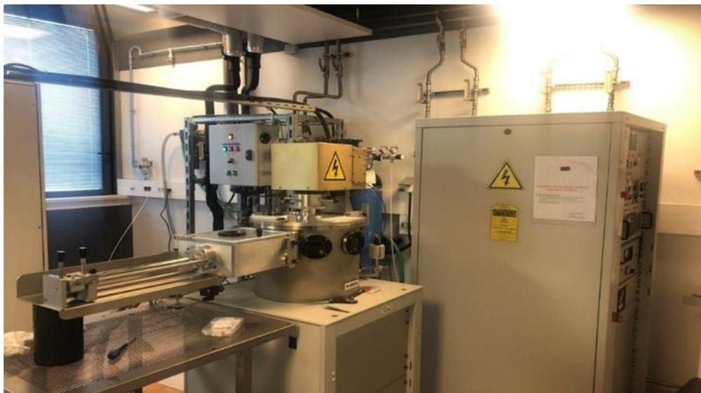
**Figure 1** : Photo de l'équipement de pulvérisation réactive cathodique magnétron utilisé pour la production de couches minces d'a-CN<sub>x</sub>.
