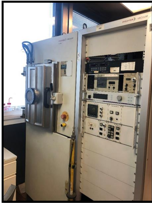
Figure 9 : Evaporateur thermique utilisé pour le dépôt de contacts métalliques à l'arrière des jonctions étudiées dans cette thèse.
