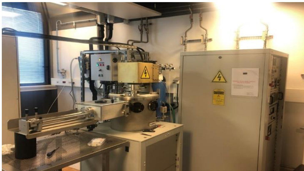
Figure 1 : Photo de l'équipement de pulvérisation réactive cathodique magnétron utilisé pour la production de couches minces d'a-CN x .
