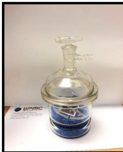
Figure 4 : Photo d'un dessiccateur rempli de gel de silice utilisé pour le stockage des échantillons après le dépôt.
