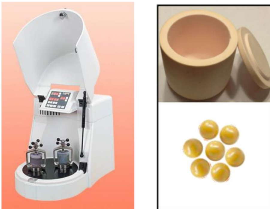
Figure 2 : Broyeur Planétaire à billes "pulverisette 7" et Illustration d'une jarre de broyage de 45 ml équipée de 7 billes de 15 mm.
