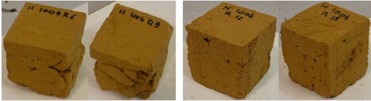
Figure 2. 7 : Briques de terre références ayant été testées avec lits de sable. A gauche, deux briques non retenues. A droite, deux briques retenues.
