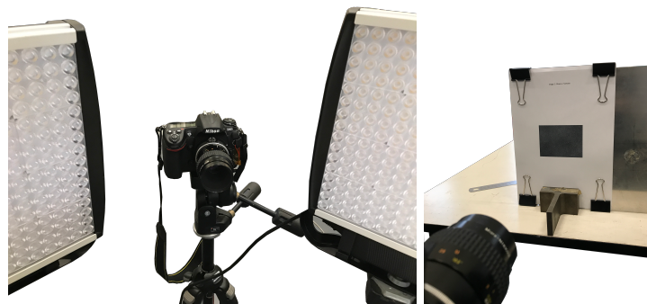
FIGURE 3.7: Montage expérimental pour la capture des textures de mouchetis
