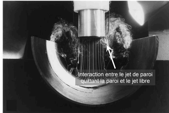
FIGURE 4.4: Visualisation par fumée d'un jet en impact sur une plaque semi-cylindrique pour un nombre de Reynolds Re_D = 6\,000 , une distance jet-plaque H/D = 2 et une courbure relative D/d = 0.29 . Tiré de Cornaro et al. (1999) .
