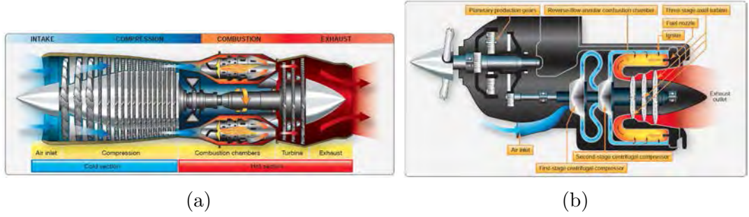
FIGURE 1.3: Schéma de principe d'un turboréacteur utilisé pour la propulsion à réaction (a) et d'un turbopropulseur utilisé pour la génération de puissance sur un arbre de sortie afin d'entraîner une hélice ou un rotor (b). Tiré de Airplane Flying Handbook, FAA- H-8083-38 (2016) .
