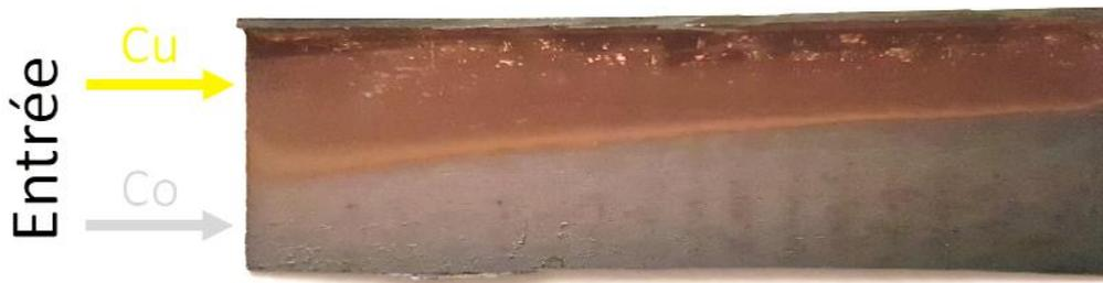
**Figure V-4.** Photographie du dépôt Cu(octane),Co sur la face du bas d'un GO CFRP de 60 mm de long.
