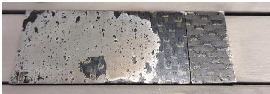
**Figure IV-14.** Dépôt de Fe sur un substrat CFRP.
