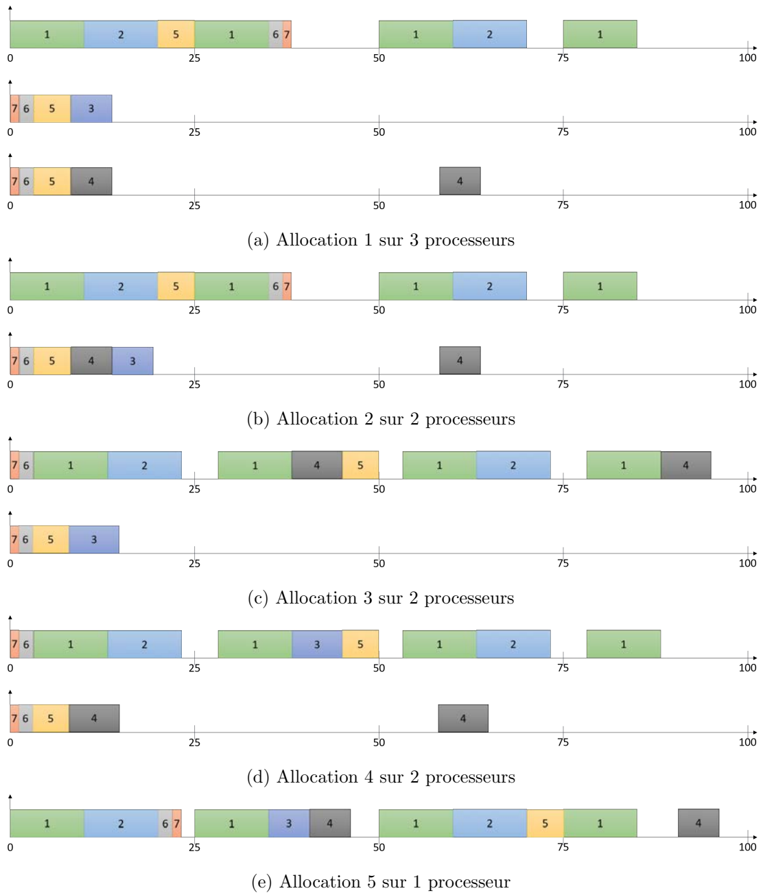
FIGURE 5.5 Allocations et ordonnancements des 5 allocations valides du système VMSA - Hypothèse : distribution d'une seule voie de l'AMC
