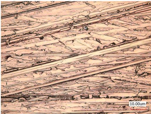
**FIGURE 3.17** – Finition grain 2400 et grossissement ×150
