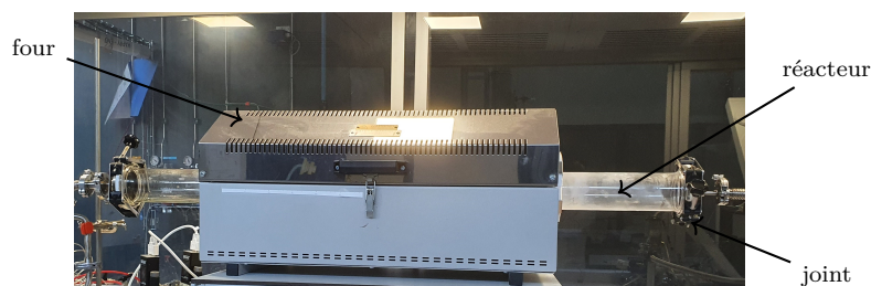
FIGURE 3.2 – Réacteur piston placé au sein du four
