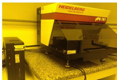
FIGURE 3.8 – Système de photolithographie directe par laser  $\mu\text{PG 101}$
