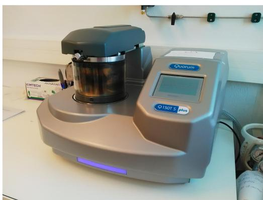
FIGURE 3.14 – Système de dépôt par pulvérisation cathodique magnétron Quorum Q150T Plus, utilisé pour les dépôts d'argent.
