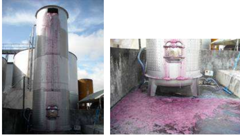
Figure 86 : Photos illustrant les débordements visibles en cours de fermentation à l'échelle industrielle (120 hL)
