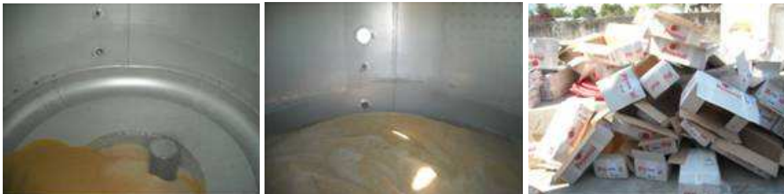
Figure 85 : Photos illustrant le chargement des billes de S.cerevisiae et Sch.pombe dans la cuve industrielle (120 hL) pour la phase de réhydratation
