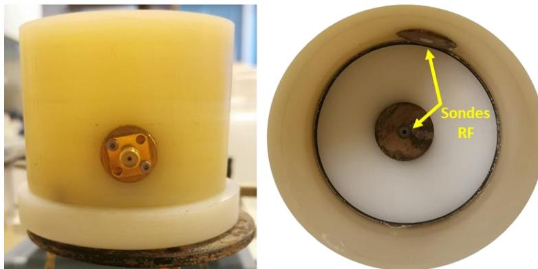
Figure 43 : Photographies du capteur à deux sondes (extérieur/intérieur).
