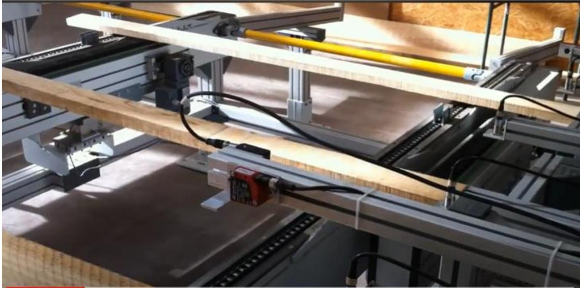
Photo n° 6 : Machine de classement xyloclass
