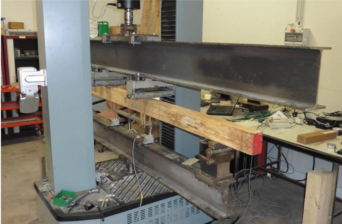
Photo n° 8 : Essai de vérification des mesures de déplacements
