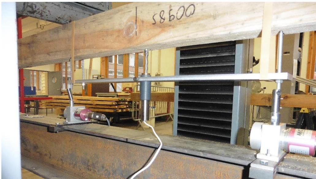
Photo n° 9 : Dispositif de vérification des mesures de déplacements
