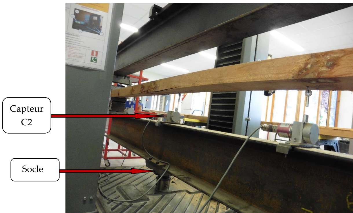
Figure n° 28 : Mise en œuvre des essais de flexion étendue
