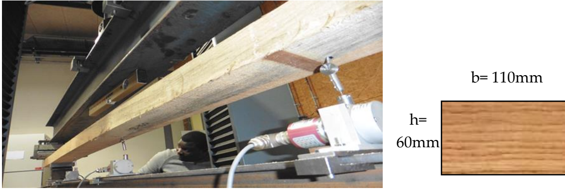
Photo n° 7 : Mise en œuvre des essais de flexion étendue proposés : disposition à plat
