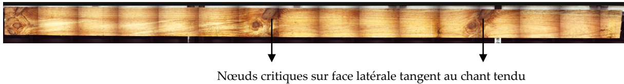
Figure n° 50 : Mise en évidence de positions critiques de nœuds
