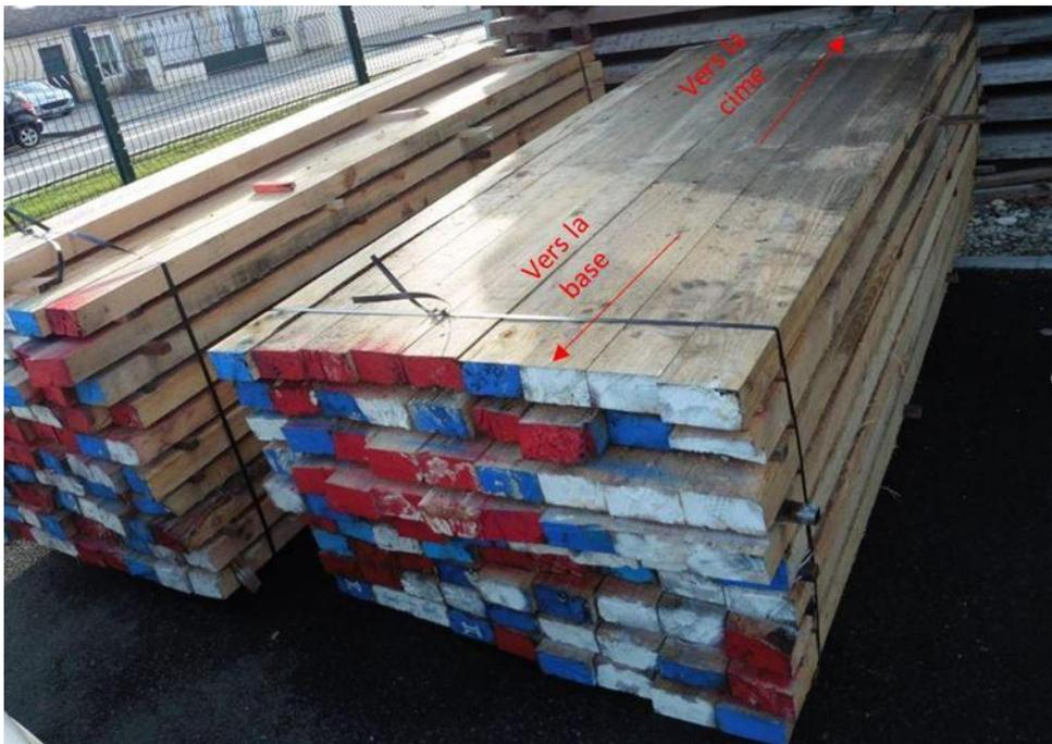
*Photo n° 10 : Sciages référencés suivant l'orientation en hauteur dans les arbres*
