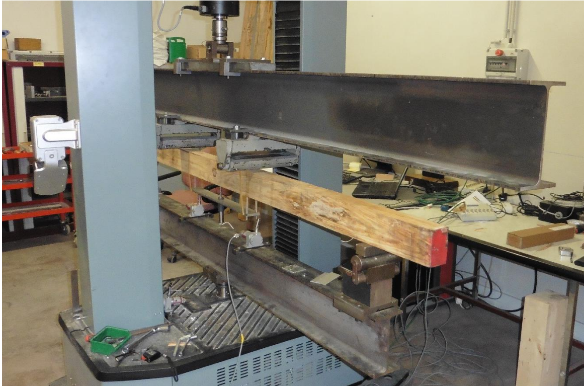
Photo n° 8 : Essai de vérification des mesures de déplacements
