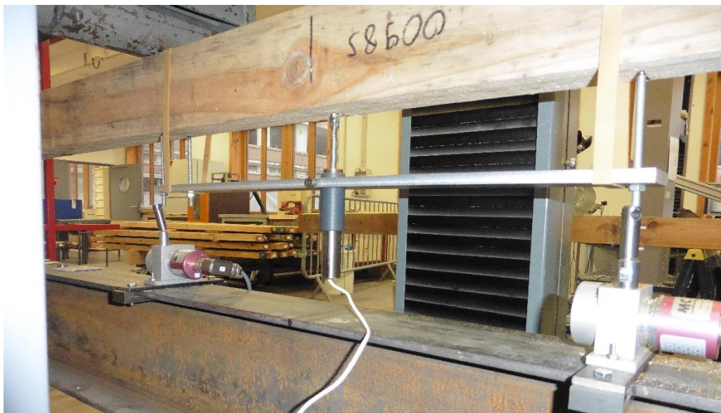
Photo n° 9 : Dispositif de vérification des mesures de déplacements
