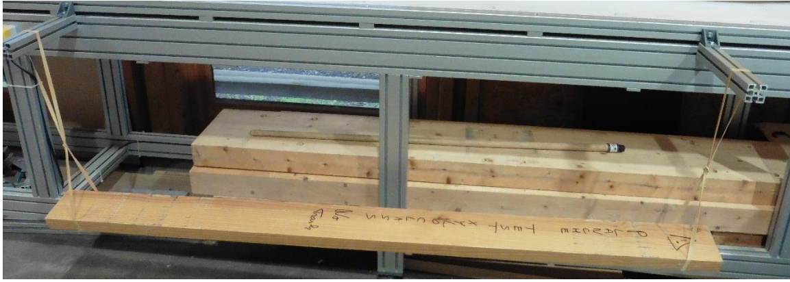
Photo n° 5 : Mise en œuvre des essais vibratoires de flexion à plat
