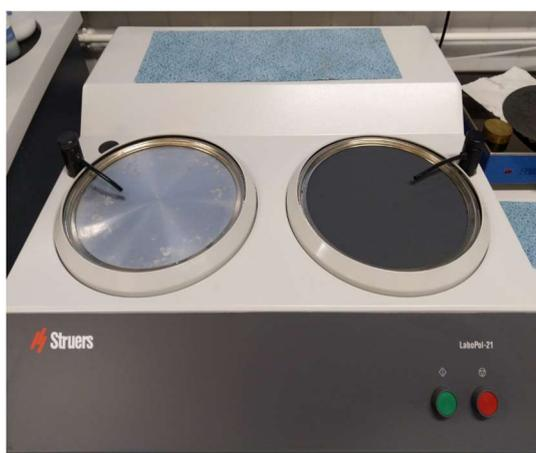
**Figure 30. Machine de polissage manuel LaboPol-21**
