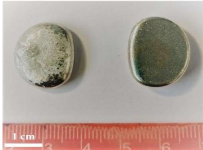
**Figure 40. Échantillon globule d'alliage de brasure SAC305**
