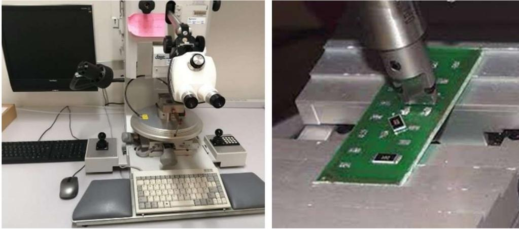
**Figure 59.** Image de la machine de cisaillement Microtesteur Dage séries 4000.
