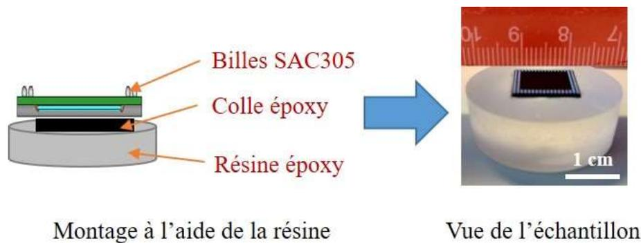
**Figure 38. Schéma montrant un exemple de la préparation du boîtier BGA avec des billes polies**
