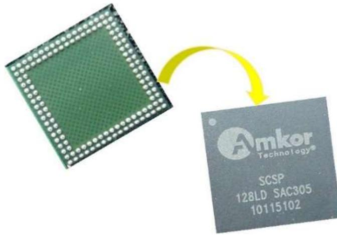
**Figure 35. Exemple de boîtier BGA top non reporté fourni par Amkor**
