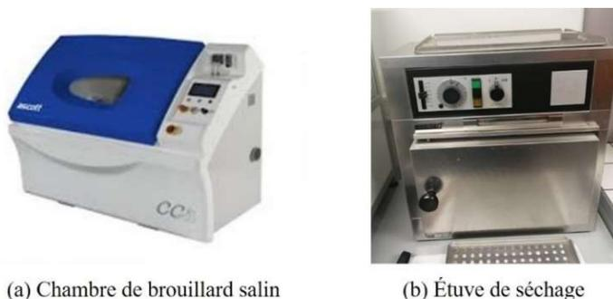
**Figure 27. (a) Chambre de brouillard salin Ascott CC450iP ; (b) Étuve de séchage Memmert**
