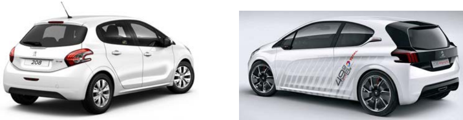
FIGURE 1.2 – Deux versions de la Peugeot 208. À gauche, la version classique disponible à la vente. À droite, la version HYbrid FE : démonstrateur technologique rejetant moins de 49 grammes de CO_2 par kilomètre. Le modèle basse consommation présente des lignes retravaillées et notamment un arrière à pan vertical permettant de réduire la traînée aérodynamique.
