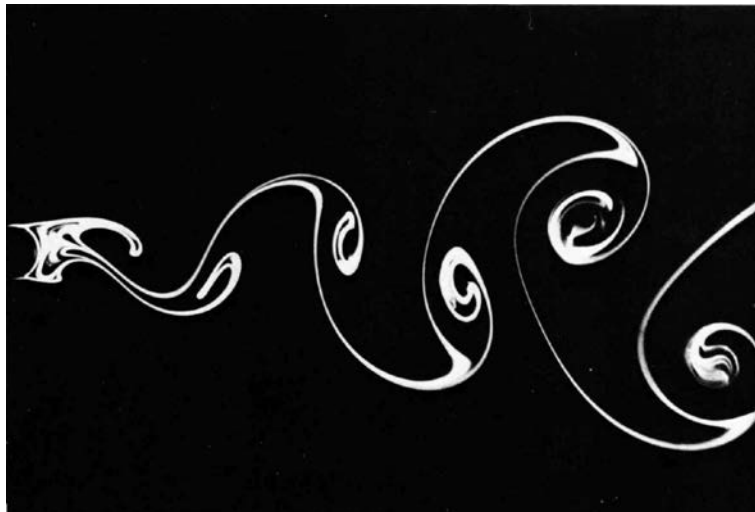
FIGURE 1.4 – Allée de tourbillons de von Kármán dans le sillage d'un cylindre circulaire pour Re=140 . Figure d'après Van Dyke (1982).
