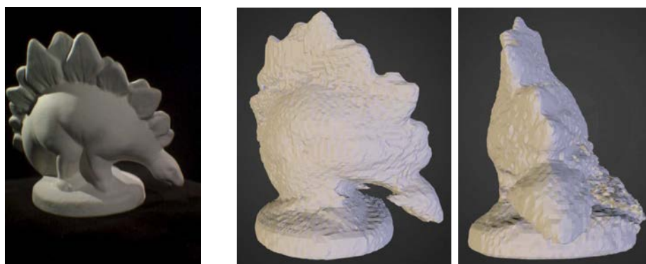
(a) Une des 16 images utilisées pour la reconstruction (provenant du jeu de données de Middlebury 1 ) (b) Deux vues de la reconstruction 3D obtenue, proposée par [78]
