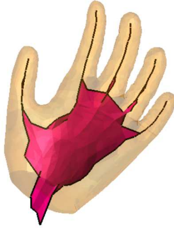
FIGURE 2.10 – Illustration des parties surfaciques et curvilignes d’un squelette 3D. Ici, les doigts de la main correspondent à des parties curvilignes, tandis que la paume de la main correspond à une partie surfacique. Image provenant de [4].
