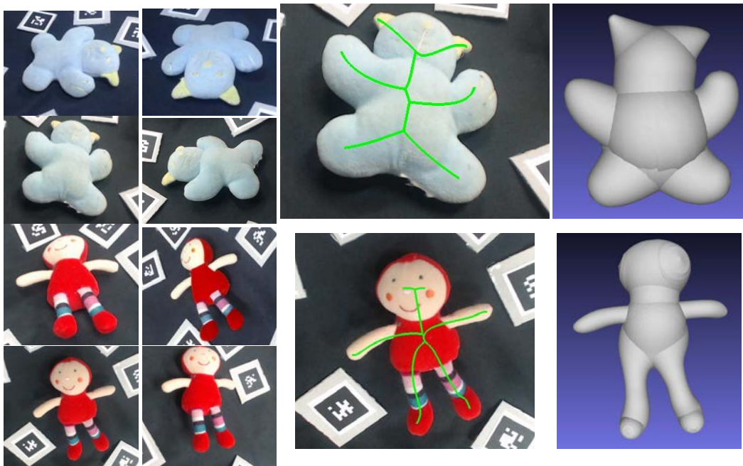
FIGURE 5.15 – Deux reconstructions effectuées avec la méthode proposée. Les images acquises sont présentées à gauche, et le squelette ainsi qu'un maillage sont présentés à droite.
