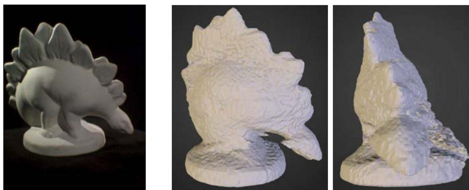
(a) Une des 16 images utilisées pour la reconstruction (provenant du jeu de données de Middlebury<sup>1</sup>) (b) Deux vues de la reconstruction 3D obtenue, proposée par [78]
