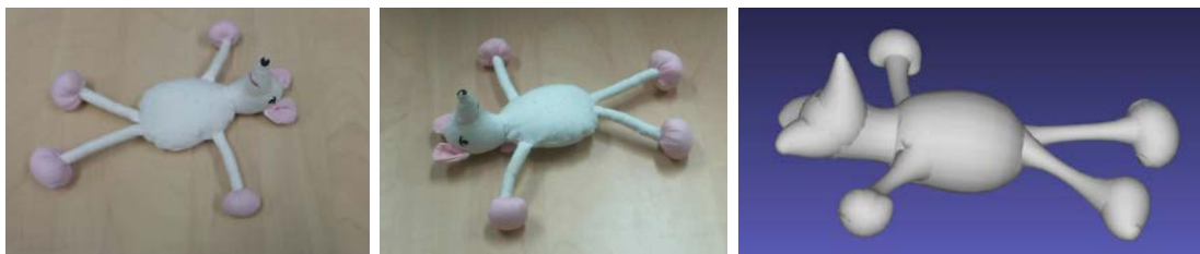
FIGURE 1.4 – Entrée (images d'un objet, à gauche et au centre) et sortie (maillage associé au squelette 3D, à droite) de la reconstruction basée squelette.
