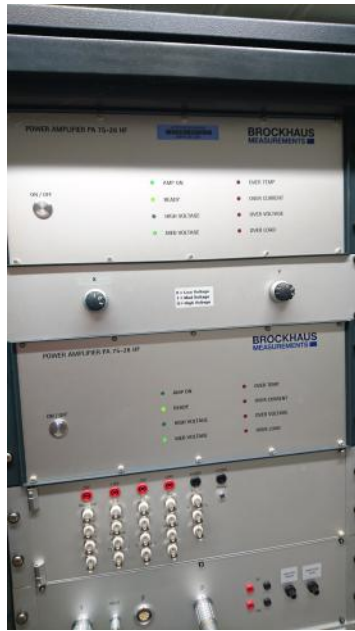
FIGURE II.1 – Amplificateurs servant de source de puissance
