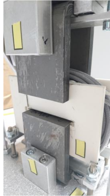
FIGURE II.4 – Zoom sur le SST - Circuit magnétique ouvert
