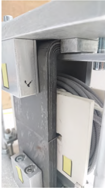
FIGURE II.3 – Zoom sur le SST - Circuit magnétique fermé
