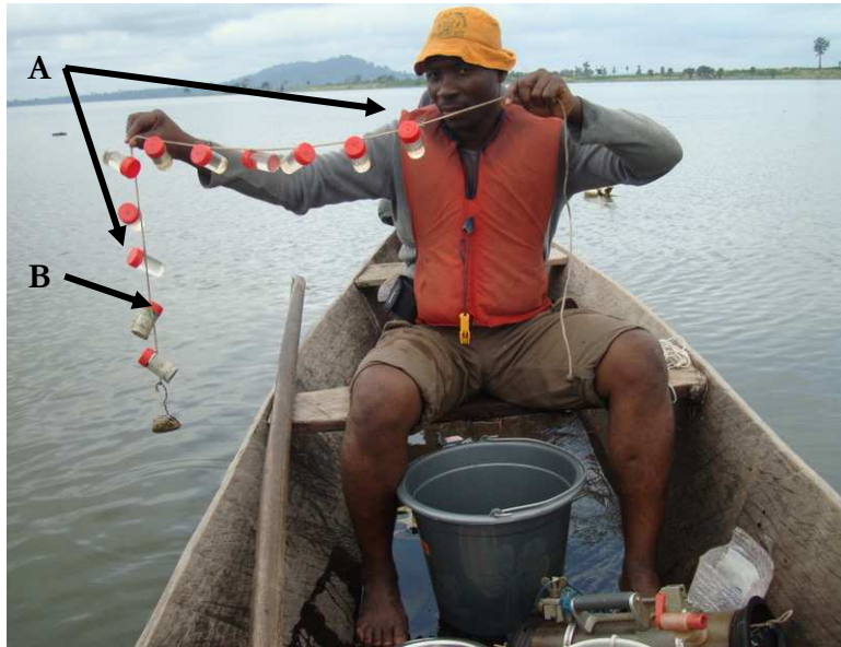
Photographie 11. Matériel de mesure de la quantité d'oxygène dissous dans les différentes bouteilles (A : transparentes, B : opaques).
