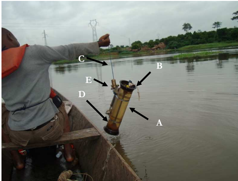
Photographie 3. Bouteille hydrologique de type Van Dorn utilisée pour le prélèvement des algues pélagiques. A : tube PVC. B : ventouse. C : corde graduée. D : robinet. E : messenger.
