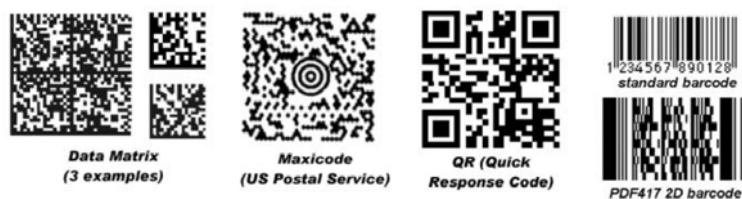
FIGURE 5.3: Un code-barres standard unidimensionnel et des systèmes de codes-barres bidimensionnels. Les codes-barres standard et de type PDF417 sont prévus pour une lecture par scanner laser. Les codes-barres 2D de type Data Matrix, Maxicode et QR sont conçus pour porter de l'information et sont lus en étant positionnés face à la caméra. Ils sont mal adaptés à une utilisation dans des systèmes de marqueurs.
