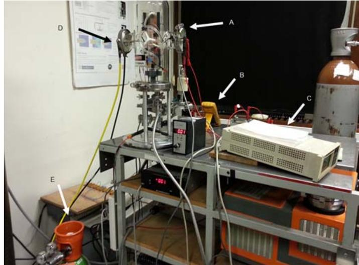
FIGURE 4.1 – Dispositif expérimental : (A) L'enceinte à vide (B) multimètre (C) Jauge absolue en pression (D) Hublot avec connectique SMA relié à l'analyseur vectoriel (E) Gaz Néon/Xénon
