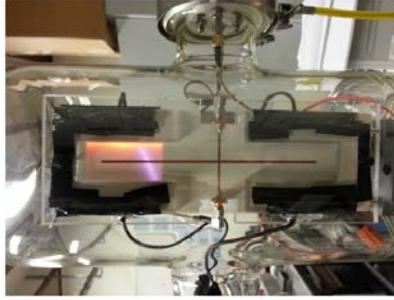
FIGURE 4.40 – Image de décharge plasma DC, "plasma B.F" allumé à  $P = 3Torr$
