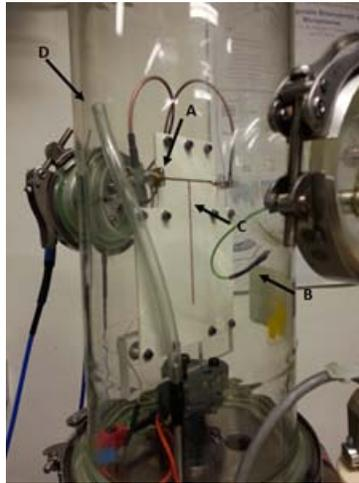
FIGURE 4.13 – (A) connectique SMA (B) fil relié aux électrodes (C) résonateur en T (D) entrée du gaz
