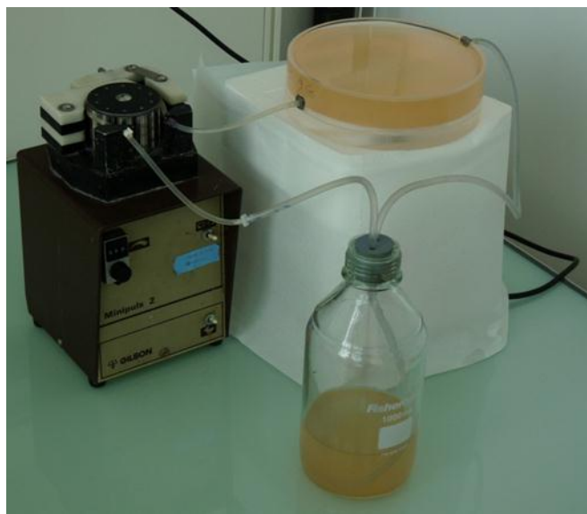
Figure II-38 : Dispositif expérimental servant à étudier la colonisation d' Algoriphagus yeomjeoni sur des coupons en acier inoxydable.
