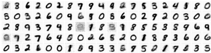
FIGURE 2.5 – visualisation des poids des 28x28 connexions synaptiques pour chacun des 100 neurones du modèle de Diehl & Cook [12] après apprentissage.
