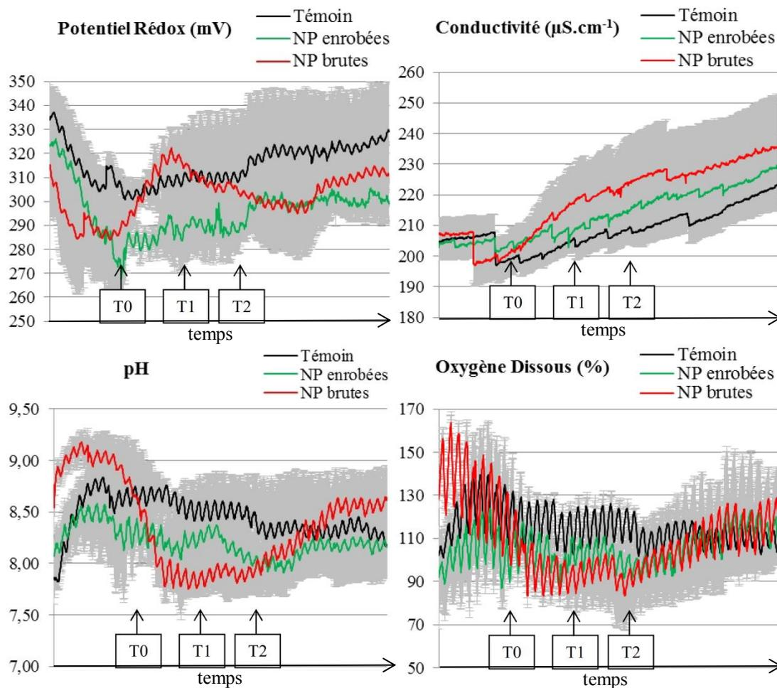
**Figure 3** : Courbes de variation de potentiel rédox, conductivité, pH et oxygène dissous (valeurs moyennes) en fonction du temps. Les zones grisées représentent les valeurs d'écart-type. T0 : première addition de NP ; T1 : introduction des larves de chironome ; T2 : introduction des larves de pleurodèle.
