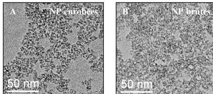
**Figure 1 :** Observation en MET (Jeol Jem 2100, 200Kv, HR) des NP de CeO<sub>2</sub>. (A) NP enrobées de citrate ; (B) NP brutes.
