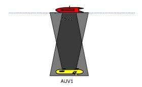
Figure A.1 – Representation de la zone de communication entre AUV1 et ASV1. L'intersection des zones de communication entre les deux véhicules (de couleur noir) représente l'emplacement que l'un des véhicule peut avoir afin de communiquer, à ce moment, avec l'autre véhicule.
