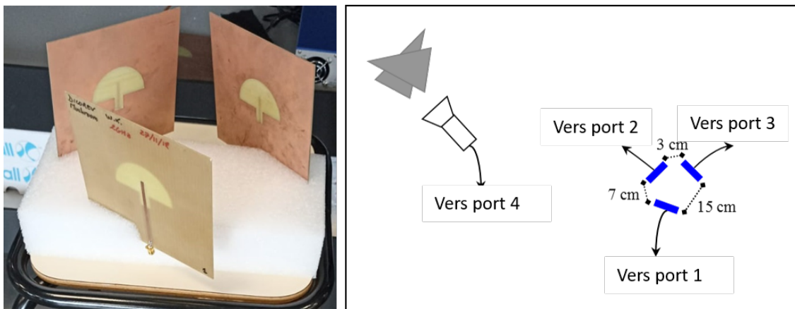
FIGURE 4.52 – A gauche : Positions relatives des trois antennes imprimées - A droite : Dispositif de mesure dans la CR d'ESYCOM avec une antenne cornet pointant vers le brasseur en excitation et 3 antennes imprimées en réception.
