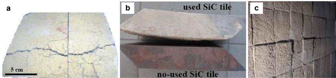
**Figure I-9: Dégradations de tuiles employées dans des U.V.E.O.M. : (a) Fissuration des tuiles (Prigent, P. et al., 2009), (b) Déformation des tuiles et (c) déformation des parois (Doncieux, A. et al., 2009).**
