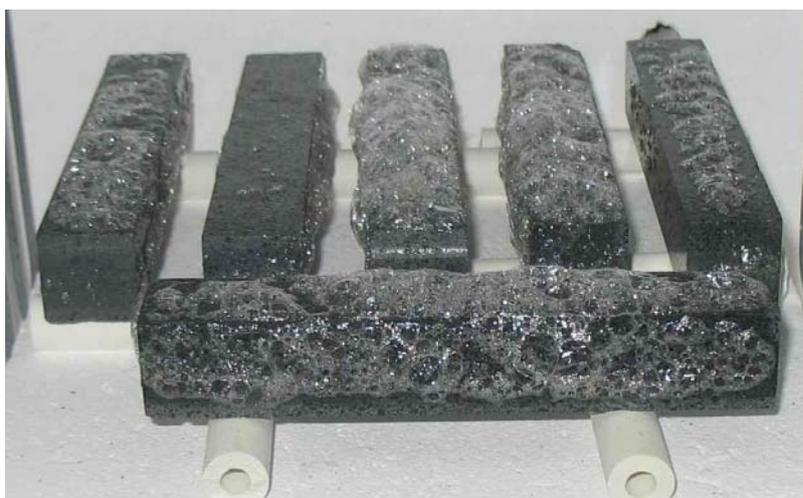
Figure A- 12 : Exsudation de phases vitreuses en grande quantité sur des éprouvettes de flexion 4-points du matériau SiC-SiAlON après 500 heures d'oxydation à 1200°C, sous air ambiant.
