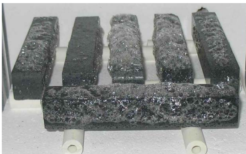
Figure A- 12 : Exsudation de phases vitreuses en grande quantité sur des éprouvettes de flexion 4-points du matériau SiC-SiAlON après 500 heures d'oxydation à 1200°C, sous air ambiant.
