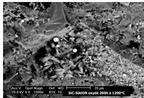
Figure IV- 37 : Site C : Morphologie d'un élément structurant éloigné d'une macroporosité après oxydation du matériau SiC-SiAlON à 1200°C-200h, sous air ambiant.
