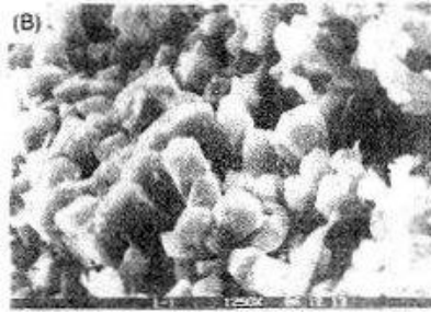
Figure I-23 : Réfractaire SiC-Si 3 N 4 : Formation de cristaux de \text{Si}_2\text{ON}_2 liée à la présence d'oxygène dans le gaz nitrurant (Peng, D. Y. et al., 1989).
