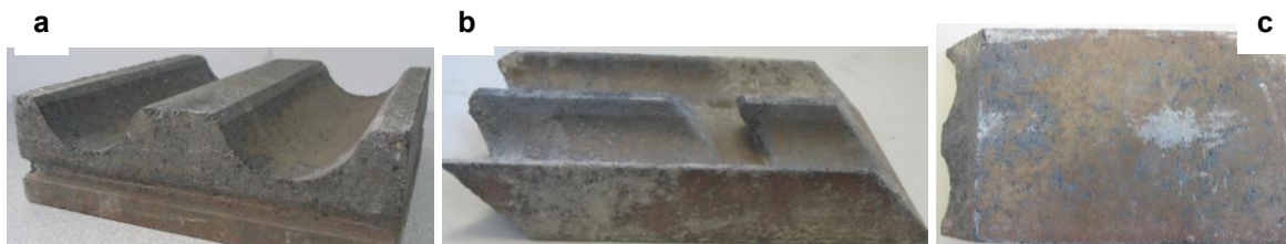
Figure A- 3 : (a) Face arrière de la tuile SiC-oxyde de géométrie A ; (b) Face arrière de la tuile SiC-oxyde de géométrie B ; (c) Face avant de la tuile SiC-oxyde de géométrie B.
