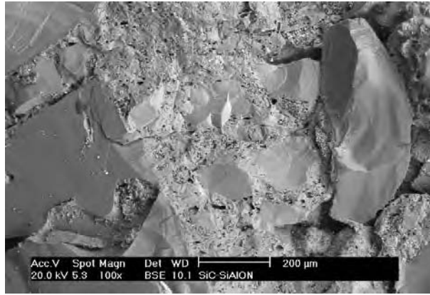
Figure III- 9 : Faciès de rupture d'une éprouvette de flexion 4-points du matériau SiC-SiAlON à l'état brut d'élaboration (zone en traction) rompue à 20°C : rupture transgranulaire.
