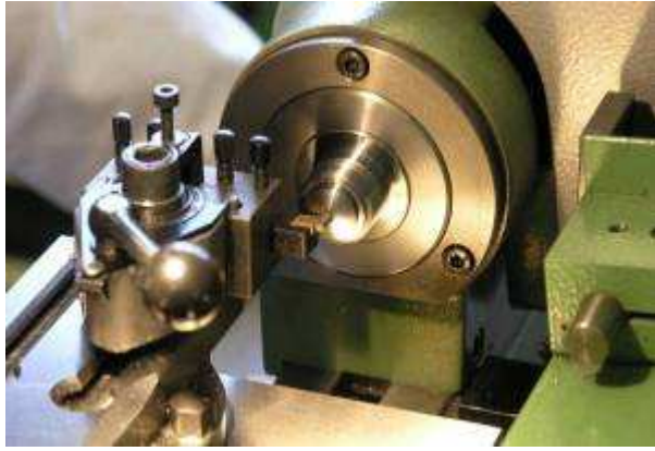
Figure III-27 : L'usinage du barreau de composite
