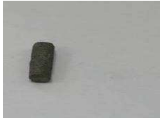
Figure III-27 : L'usinage du barreau de composite
