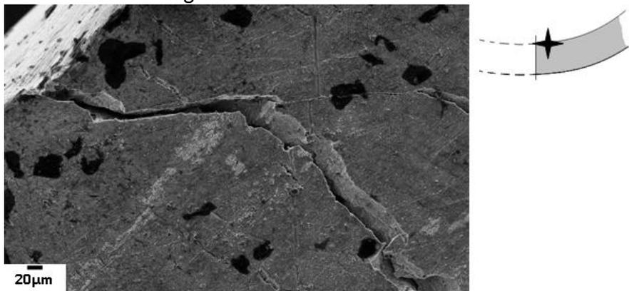
**Figure 52.** Etat de la zone préablement emboutie en V après rupture de l'éprouvette en dehors du V. Essai de traction lente conduit à une vitesse initiale locale de  $3,2.10^{-9}s^{-1}$  sur l'alliage TD707.
