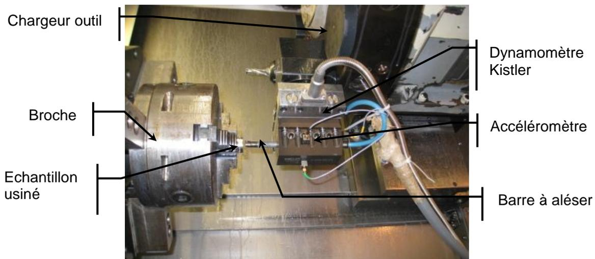
Figure D.2 : Montage expérimental de tournage.
