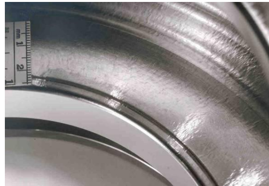
Figure A.2 : Aspect peau d'orange sur du TA6V tourné
