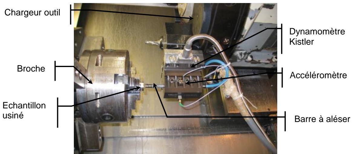
Figure D.2 : Montage expérimental de tournage.
