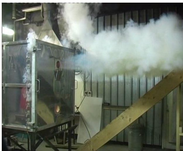
Figure 1.9 - Explosion des fumées dans un incendie confiné (Fleischmann & Chen, 2013).
