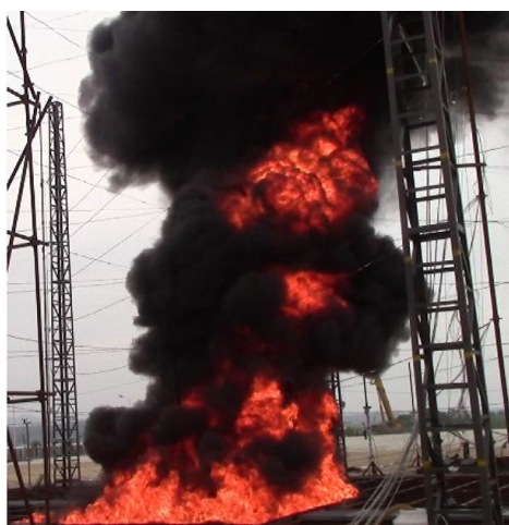
Figure 1.4 - Feu de nappe à grande échelle. Surface du bac de combustible de 25 m 2 (Tao, et al., 2020).
