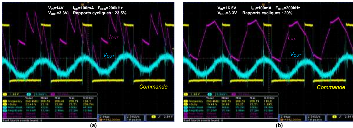
Figure 5-35 - Observation de la tension de sortie (bleu) et du courant de sortie (violet) - Ondulation importante à F_{DEC}
