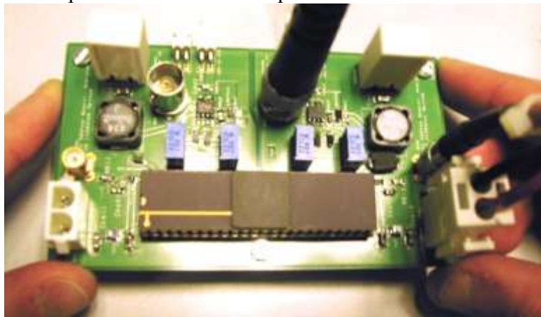
Figure 4-13 - Photographie de la carte de test (Schéma de la Figure 4-12 implanté deux fois)
