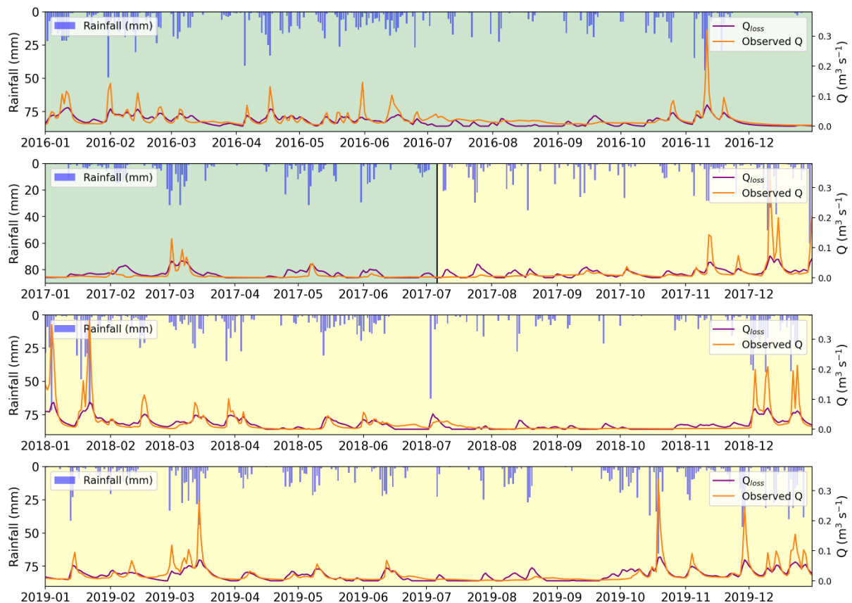
Figure 178– Annexe 9 : Évolution du débit mesuré et du Q_{loss} en fonction du temps. Chaque partie représente une année civile. Le fond de couleur indique si la période est en calibration (vert) ou en validation (beige).
