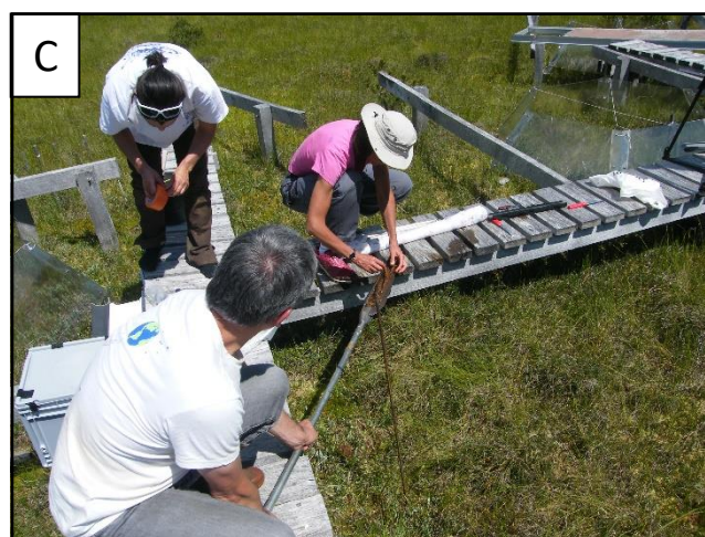
Figure 167 : Annexe 3 – Figure 2: A : Photo du dispositif. B : Schéma du dispositif montrant les profondeurs de crépissage. C : Prélèvement d'une carotte de tourbe.
