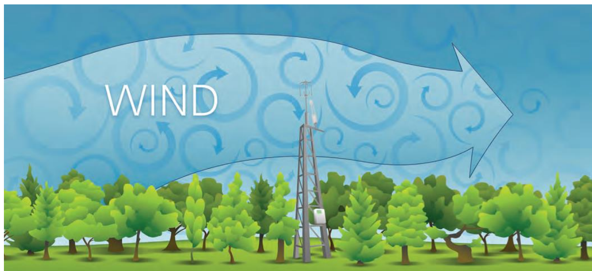
Figure 68 : Illustration du flux d'air dans la couche limite de l'atmosphère : le flux d'air peut être synthétisé comme un flux d'air horizontal (le vent) incluant de nombreux tourbillons dans les 3 dimensions de l'espace (Burba, 2013).
