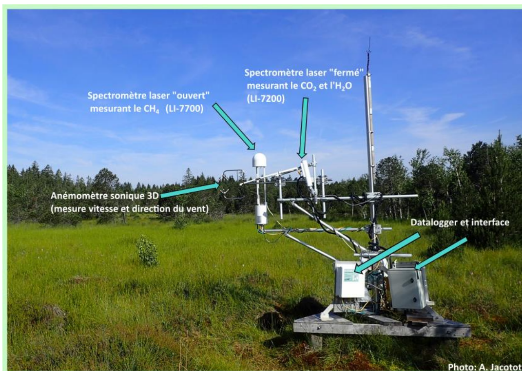
Figure 75 : Présentation de l'eddy-covariance installée sur la tourbière active du Forbonnet (Frasne). Photo : A. Jacotot ; https://medihal.archives-ouvertes.fr/hal-03448121/thumb .
