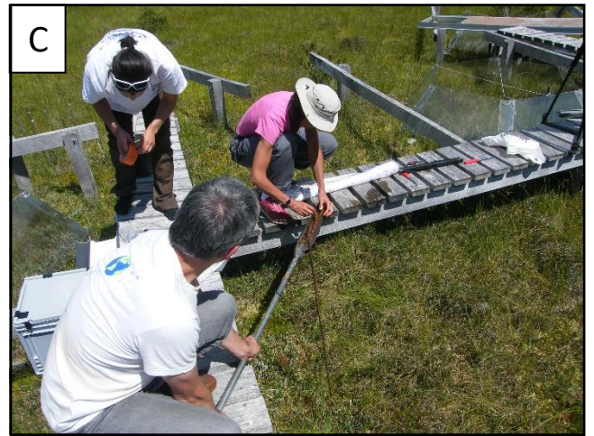
Figure 167 : Annexe 3 – Figure 2: A : Photo du dispositif. B : Schéma du dispositif montrant les profondeurs de crépilage. C : Prélèvement d'une carotte de tourbe.
