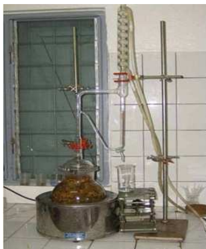
Schéma I-16: hydrodistillation par Clevenger
