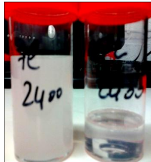
Figure 5.11 : Photo d'un essai d'extraction à V_r=2400\text{tr/min}
